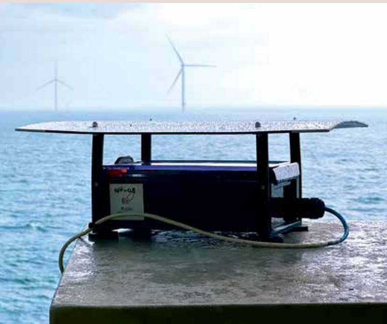
Das „Optical Pile Tracking“ liefert wichtige Daten, um den Installationsprozess und die Montage von Windkraftkomponenten vorhersehbarer zu machen.
