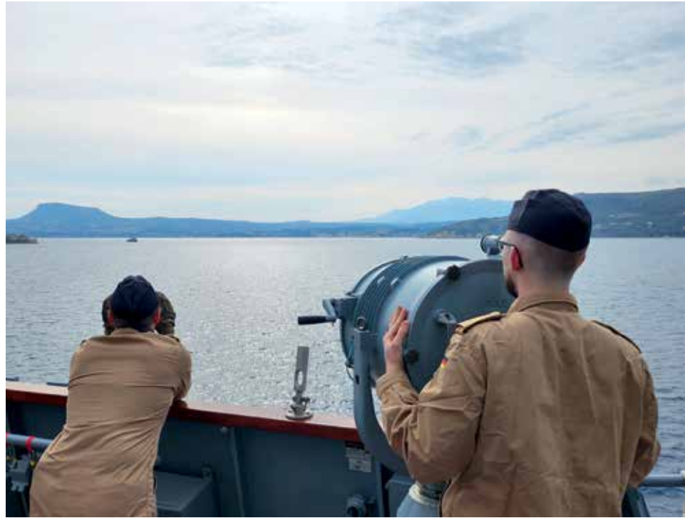
Soldaten beim Austausch von Nachrichten mit der Morselampe. Trotz modernster Technologien wird der optische Signalverkehr weiterhin als sicheres, analoges Fernmeldemittel geschätzt.
