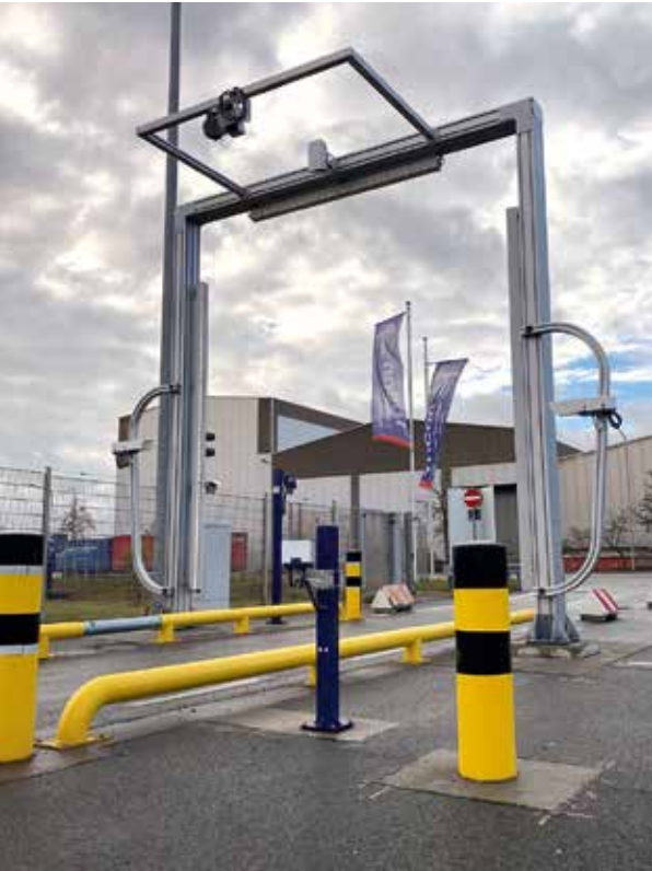
Am OCR-Gate von TriCon werden Momentaufnahmen des Zustands der Ladeinheit erstellt.
