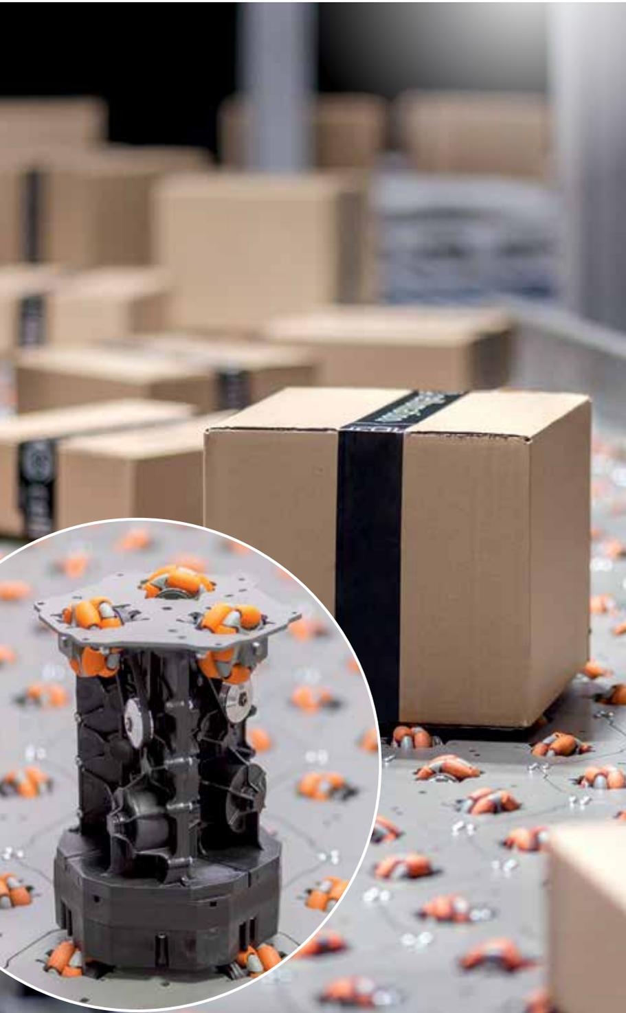
Mit der zellenbasierten Fördertechnik können Pakete effizienter sortiert und die Entladung von Containern beschleunigt werden.
