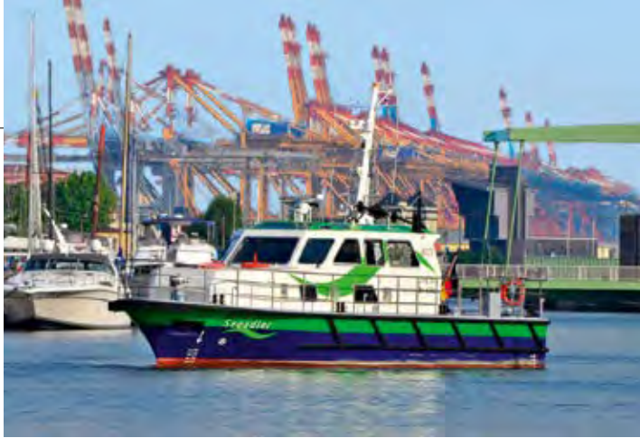
Die 2016 getaufte „Seeadler“ (I.) ist Teil der Marke „greenports“: Sie verfügt über einen Hybridantrieb, dessen abgasoptimierter Dieselmotor eine Kraftstoffersparnis von 25 Prozent ermöglicht und den Ausstoß von Stickoxid und Kohlendioxid deutlich reduziert. Die Flotte von bremenports umfasst derzeit acht E- und drei Hybridfahrzeuge.
