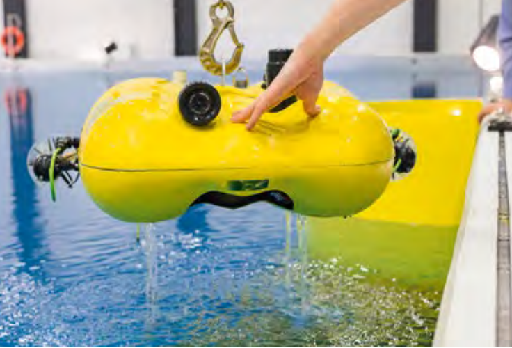
Das Dagon-AUV (Autonomous Underwater Vehicle) zur visuellen Kartenerstellung und Lokalisierung wird aus dem Wasserbecken gehoben.
