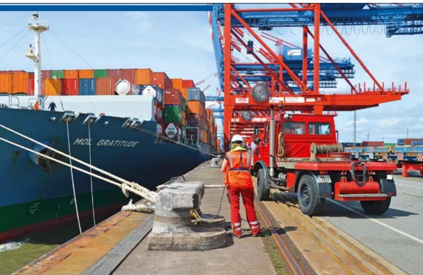
Festmacher setzen bei ihrer Arbeit außer ihrer Körperkraft auch speziell ausgestattete Unimogs mit einer 1,5-Tonnen-Winde ein.
