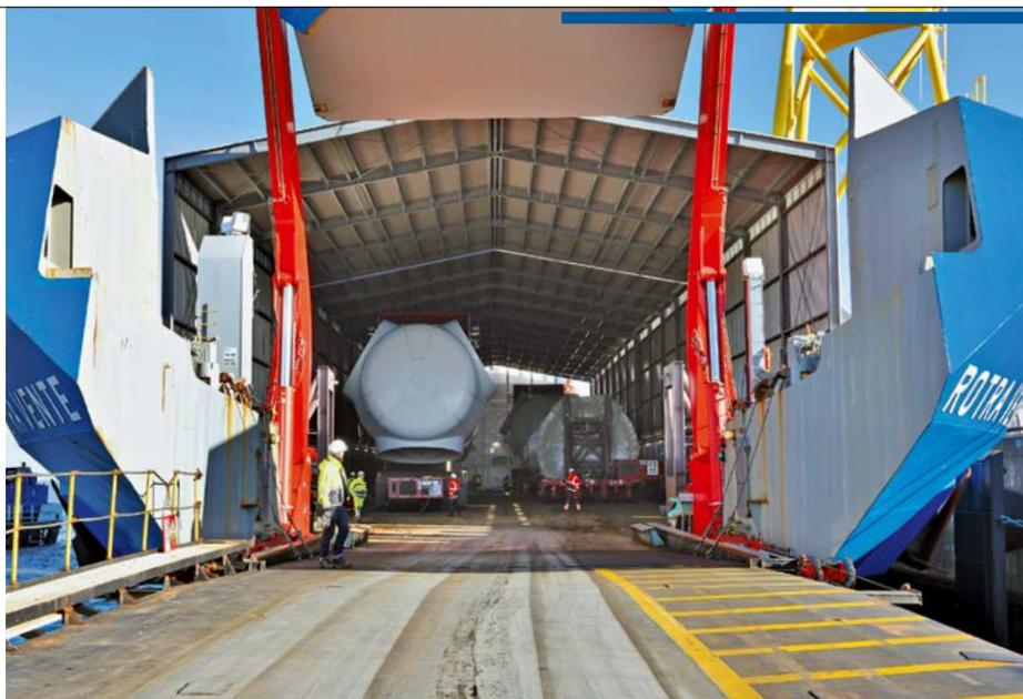
Das Transportschiff „Rotra Vente“ ist 141 Meter lang und kann mehrere Maschinenhäuser der 8-Megawatt-Anlagen aufnehmen.
