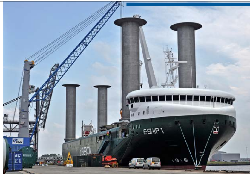
Neben einem Dieselantrieb verfügt das Projektladungsschiff „E-Ship 1“ über Flettner-Rotoren. Es ist das weltweit erste kommerzielle Rotorsegelschiff.
